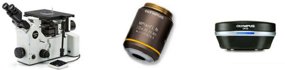
Équipement typique : microscope métallographique inversé, objectif 10X et caméra pour microscope numérique haute résolution
